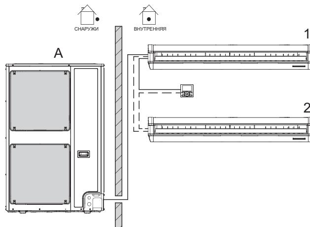
A Сплит-система или система работы в параллельном режиме
