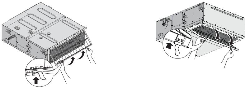
**2 Прочистите воздушный фильтр.** Воспользуйтесь пылесосом или промойте фильтр водой. Если воздушный фильтр сильно загрязнен, воспользуйтесь мягкой щеткой и нейтральным моющим средством.
