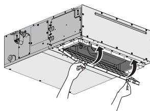
**5 Проверьте, все ли фиксаторы встали на место.**
