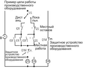
Выходные технические характеристики: Контакт нулевого напряжения
