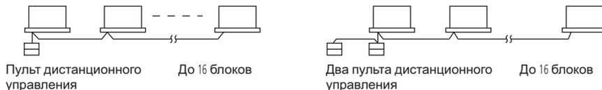
\* Зональное управление с помощью микропроцессорного сенсорного контроллера
