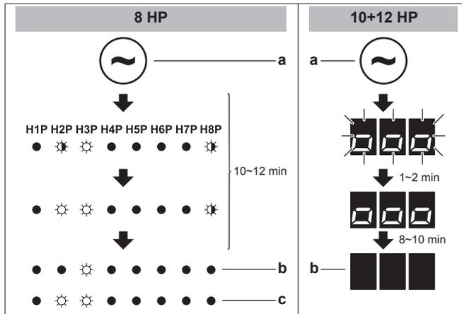
Если через 10~12 минут на дисплее не появились показания, заданные по умолчанию, проверьте, не отображается ли код неисправности на пользовательском интерфейсе внутреннего блока (или на 7-сегментном дисплее наружного блока, если речь идет о модели RXYSQ10+12). Устраните неисправность, соответствующую отображаемому коду. Во-первых, проверьте электропроводку управления.
