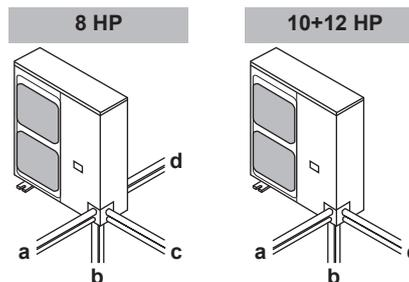
3 Если выбрана схема прокладки трубопровода, направленная вниз:
