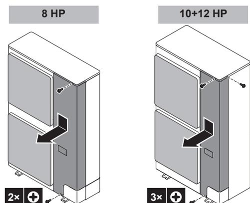
**6.3 Монтаж наружного агрегата****6.3.1 Монтаж наружного блока****Типовая последовательность действий**
