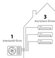
Рішення для тієї ж ситуації з використанням тільки одного зовнішнього блока мульти-спліт-системи
