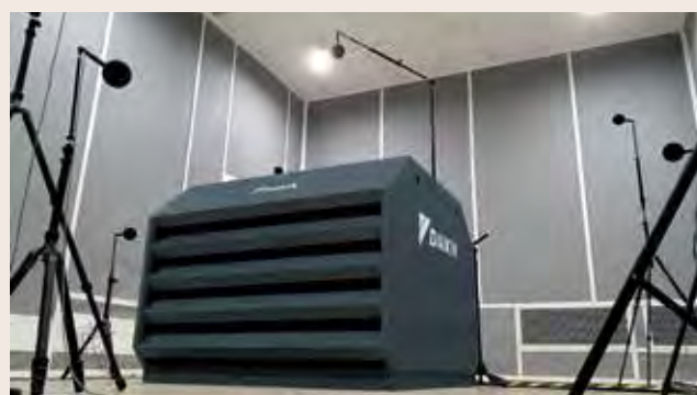
Вимірювання рівня звукової потужності в акустичній камері
